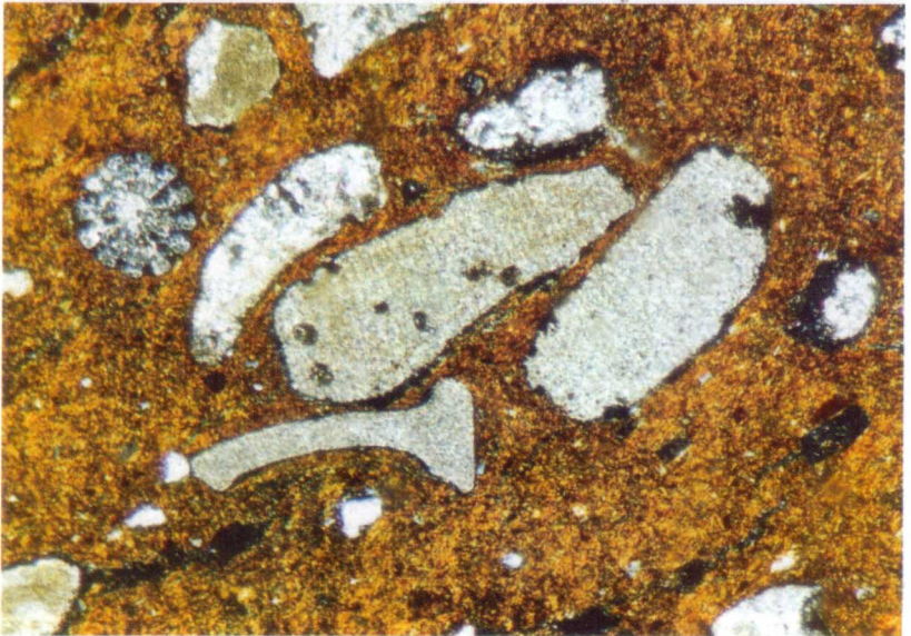
2. Segesta. SAS 5. Campione BA29. Microfotografia in sezione sottile. Esempio di ceramica con scheletro costituito da bioclasti calcarei e granuli carbonatici (gruppo 5). 60 X; nicol +.
