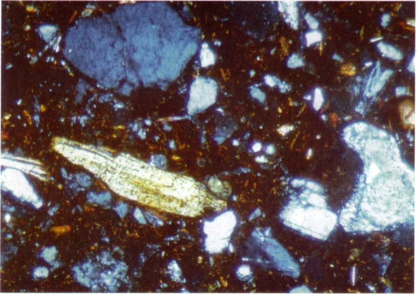
1. Segesta. SAS 5. Campione CO10. Microfotografia in sezione sottile. Esempio di ceramica del gruppo 3. Si notano alcuni clasti di quarzo, feldspato e biotite. 60 X; nicol +.
